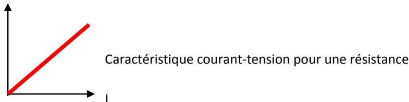
Pour obtenir la valeur  $R$  de la résistance, on calcule le coefficient directeur de sa caractéristique courant-tension. La résistance est qualifiée de dipôle linéaire car sa caractéristique tension-courant est une droite.
