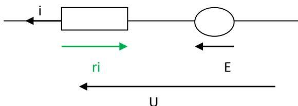
La caractéristique tension-courant d'un dipôle actif est une droite qui ne passe pas par l'origine. C'est un dipôle linéaire.
