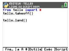
Le drone va effectuer un simple vol stationnaire de quelques minutes.
