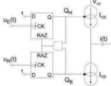
Les deux bascules D sont sensibles aux fronts montants de  $u_E(t)$  et  $u_R(t)$ , et possèdent une entrée de remise à zéro asynchrone. Les deux sorties des bascules définissent la valeur du courant de sortie  $i(t)$ . Les trois états possibles de ce détecteur, avec la valeur du courant de sortie  $i(t)$ , sont :
