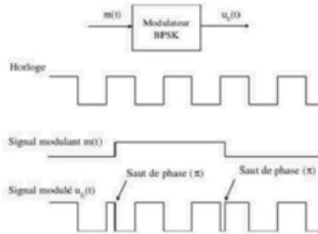
On s'intéresse à la réception du signal  $u_t(t)$ . Le dispositif que l'on souhaite réaliser est donc un démodulateur. Le démodulateur permet de retrouver le signal  $m(t)$  à partir du signal  $u_t(t)$ .
