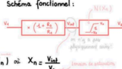
Avec  $R_1 = 1 \text{ k}\Omega$ ,  $R_2 = 4 \text{ k}\Omega$ ,  $V_0 = 13 \text{ V}$ ,  $V_1 = 1 \text{ V}$ , calculons l'amplitude du 1<sup>er</sup> harmonique de  $v_2(t)$
