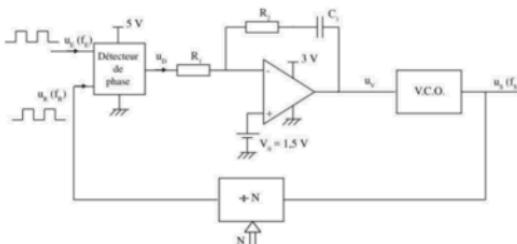
On souhaite réaliser, avec ce circuit, un synthétiseur de fréquence, fonctionnant entre 4 MHz et 5 MHz, par pas de 100 kHz, avec un temps de réponse à 5% inférieur à 1 ms, et un dépassement indiciel inférieur à 20%.
