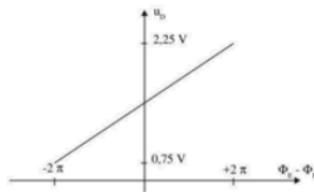
La caractéristique du V.C.O. est donnée par :  $f_s = f_e + K'_v u_v$ , avec  $K'_{v0} = -1 \text{ MHz/V}$  et  $f_e = 6 \text{ MHz}$
