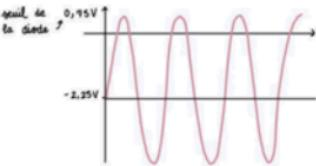
fonctionnement d'un circuit d'alignement
