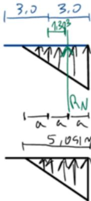
$$P_N = A_{\text{detensões}} \times \text{largura} = \frac{\text{Perí x } 3,0}{2} \times 3,0$$
