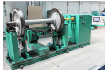
Máquina de balanceamento para rodas de locomotivas. Fonte: VTM Group .
