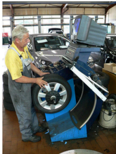
Máquina de balancear rodas automotivas. Fonte: Frank C. Müller .
