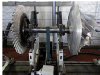
Balanceamento do rotor de um turbocompressor. Fonte: TURBOMED .
