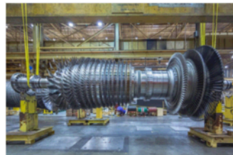
Rotor de uma turbina à gás. Fonte: GE News .
