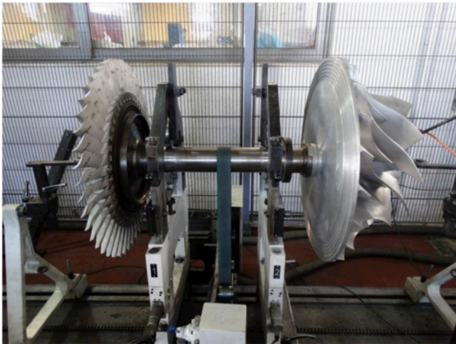
Rotor de um turbocompressor sendo balanceado. Fonte: TURBOMED - Dynamic Balancing .
