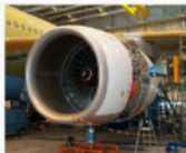
Figura 2.4: Distribución por posición fija en montaje de un motor Airbus A340-600 en la planta de Airbus en Toulouse (Francia).
