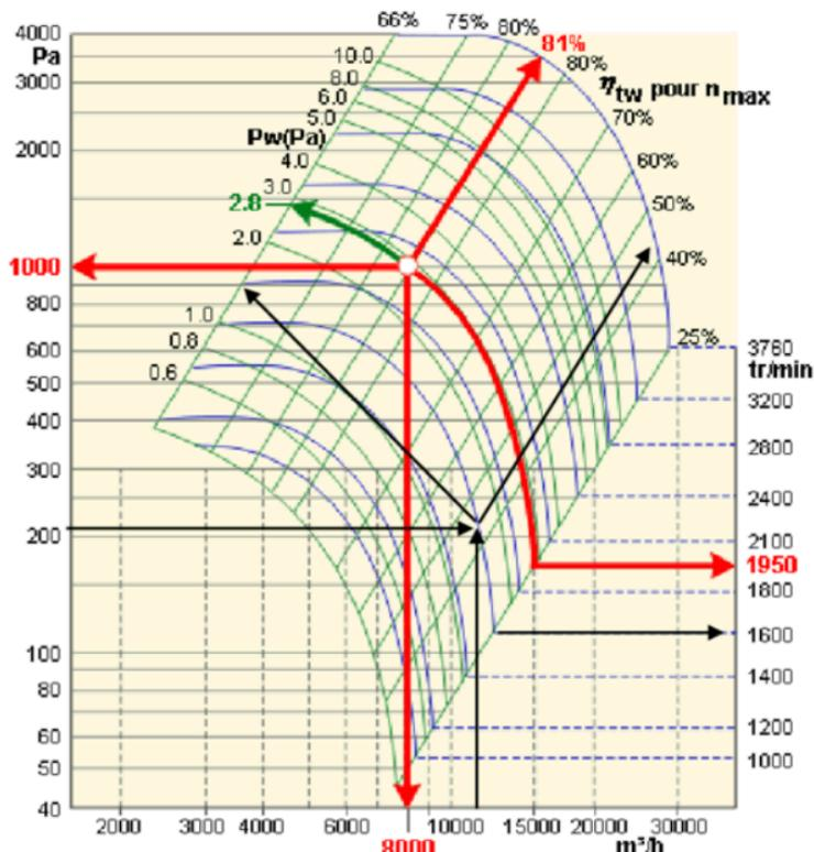
On a une ventilation qui a un rendement de 42 % avec une puissance de 1.7 kW et une vitesse angulaire de 1950 tr/min. La puissance du ventilateur est plus difficile à lire sur le graphique (1.5-1.8 kW) donc il possible de le calculer de la manière suivante :
